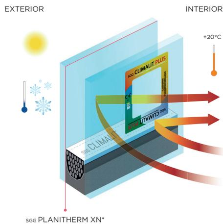
\*sGG PLANISTAR ONE debe ensamblarse siempre en doble acristalamiento sGG CLIMALIT PLUS, con la capa hacia el interior de la cámara, en posición 2 o en posición 3.
